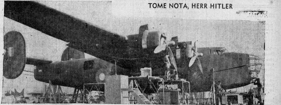
Este es uno de los aviones de bombardeo, de tres motores que construyen para Inglaterra la fábrica Consolidated Aircraft de California. Pesa 40,000 libras, vuela a 300 millas por hora, tiene un recorrido de 3,000 millas y carga 8,000 libras de explosivo en cada viaje. Imagínese el lector 300 de estos monstruos sobre Berlin.
